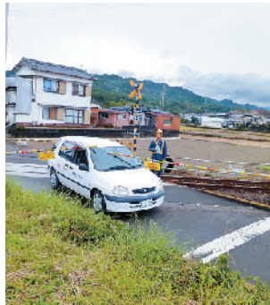
踏み切り内で遮断機が下りた場合、ゆっくり前進すると遮断機は持ち上がり、脱出できます。
